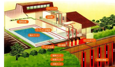
プール・温浴施設の給湯
