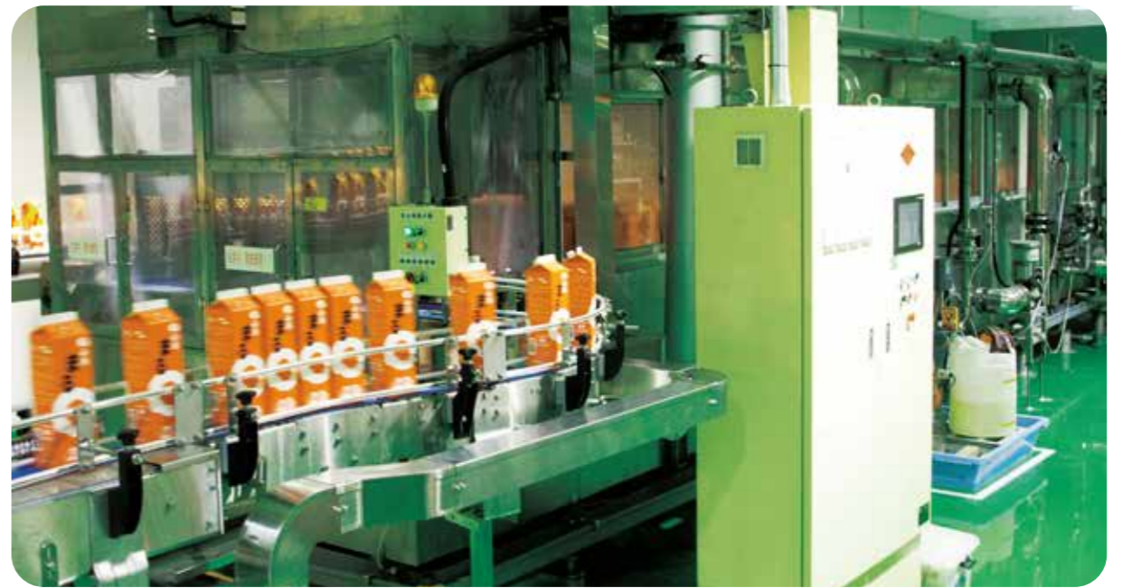
熱酒充填後の冷却工程（クーラートンネル）
