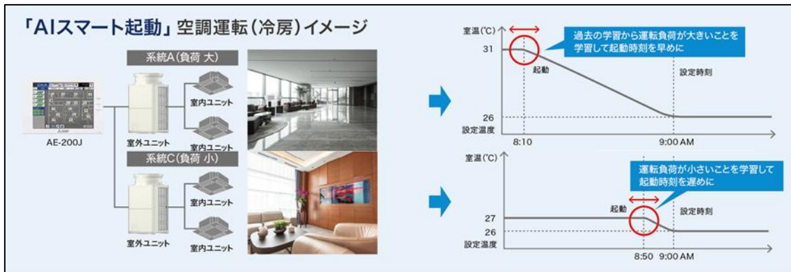
図 1 AI スマート起動時の自動起動から設定温度到達までの動作イメージ
