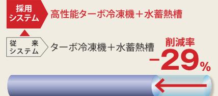
〔諸元〕2013年度のターボ冷凍機運転実績に基づき、2015年度エネルギー使用量を冷凍機運転時間より想定し比較（2014年度は更新工事中のため実績が取れず）
