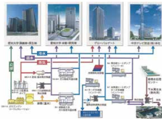
図2 下水再生水(高度処理)の多目的利用
