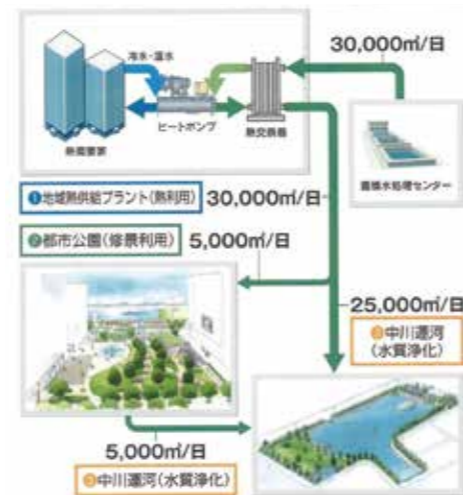
図3 地域冷暖房プラントでの下水再生水の熱利用
