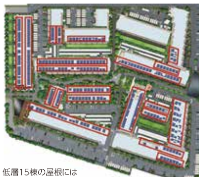
低層15棟の屋根には太陽光発電パネルを設置
