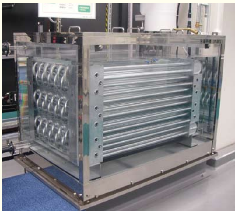
製氷状態の確認可能なアクリル張り内融式氷蓄熱槽
