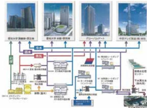
図2 下水再生水(高度処理)の多目的利用
