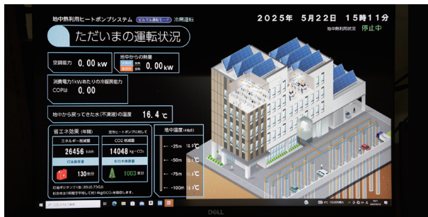
BEMSのモニター画面。リアルタイムでエネルギー状況を把握できる。
