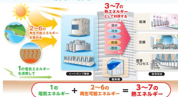
$$1 \text{ の電気エネルギー} + 2 \sim 6 \text{ の再生可能エネルギー} = 3 \sim 7 \text{ の熱エネルギー}$$
